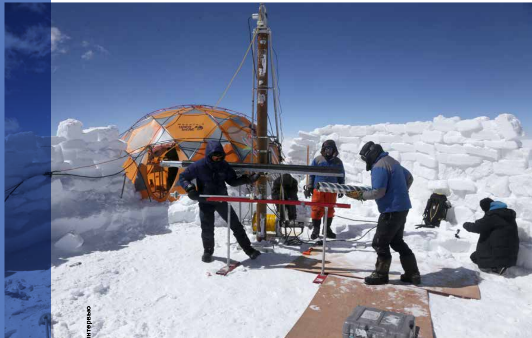
Глубокое кернавое бурение на вершине ледника Гулия (6650 м), Кунь-Лунь, Тибет, 2015 год
