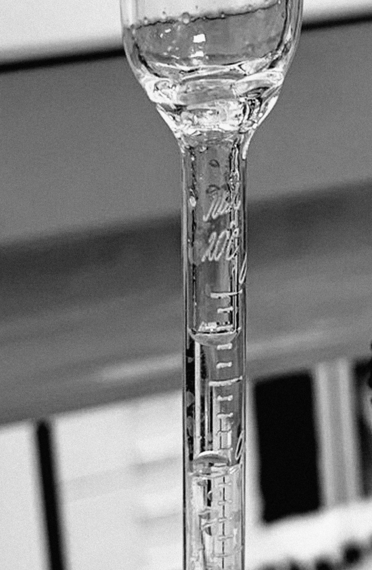
Мятное масло, выделенное на аппарате Клевенджера. Из ~500 грамм сырья получается около 15–17 мл. На фото объём — всего 0,07 мл
